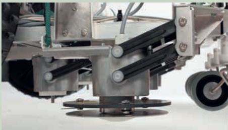
Seitenansicht: höhenverstellbarer Schneidkopf mit 15 Messern
